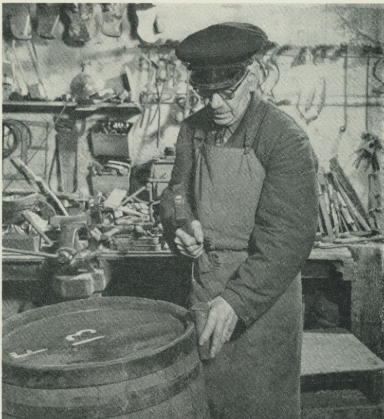
Med "drivning" och hammare slås banden ned. I bakgrunden skimtar arbetsbänken med skruvstycke och mängder av verktyg — bandknivar, "krösar", "spockskivor", "studsare" m. m.
