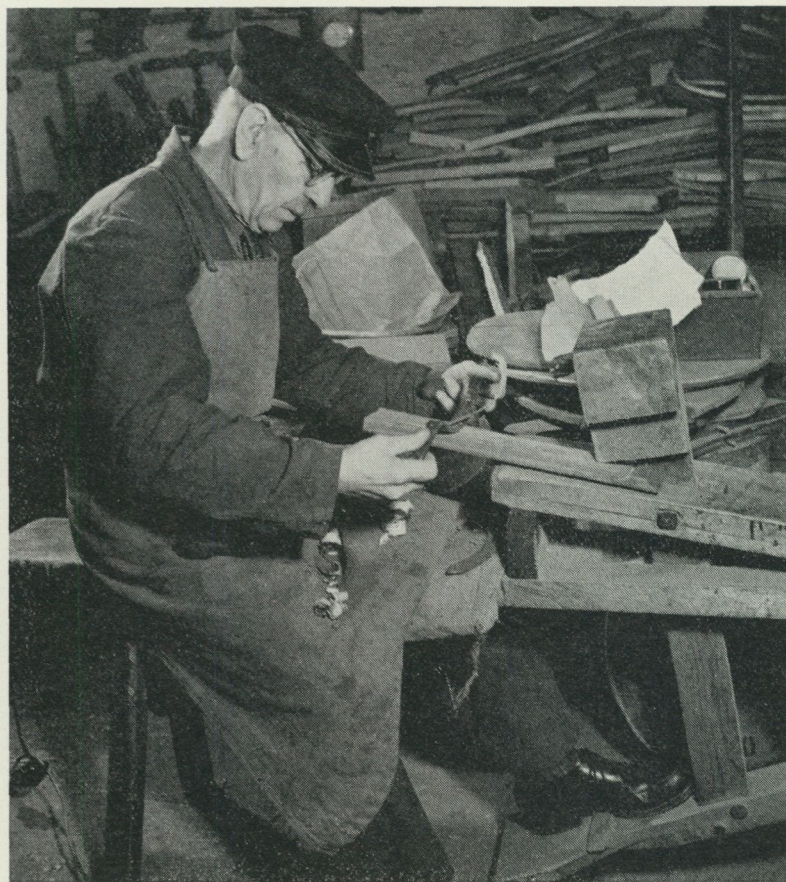
Tunnbindare Ernst Cederholm på skärbänken, "kärningen", visar hur insidan av "staven" skärs till med en krumkniv.
