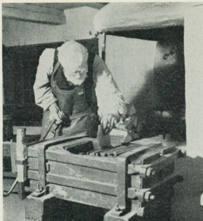
9. Stockholm siste kammakare A. W. Holm (död 1942) demonstrerar sitt hantverk i Skansens kammakarverkstad. Här förvandlar han hornämnet till en plan skiva i pressen. Foto 1939.
