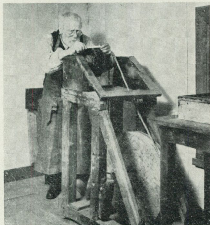
11. Den färdiga kammen poleras med lumptrissa.
