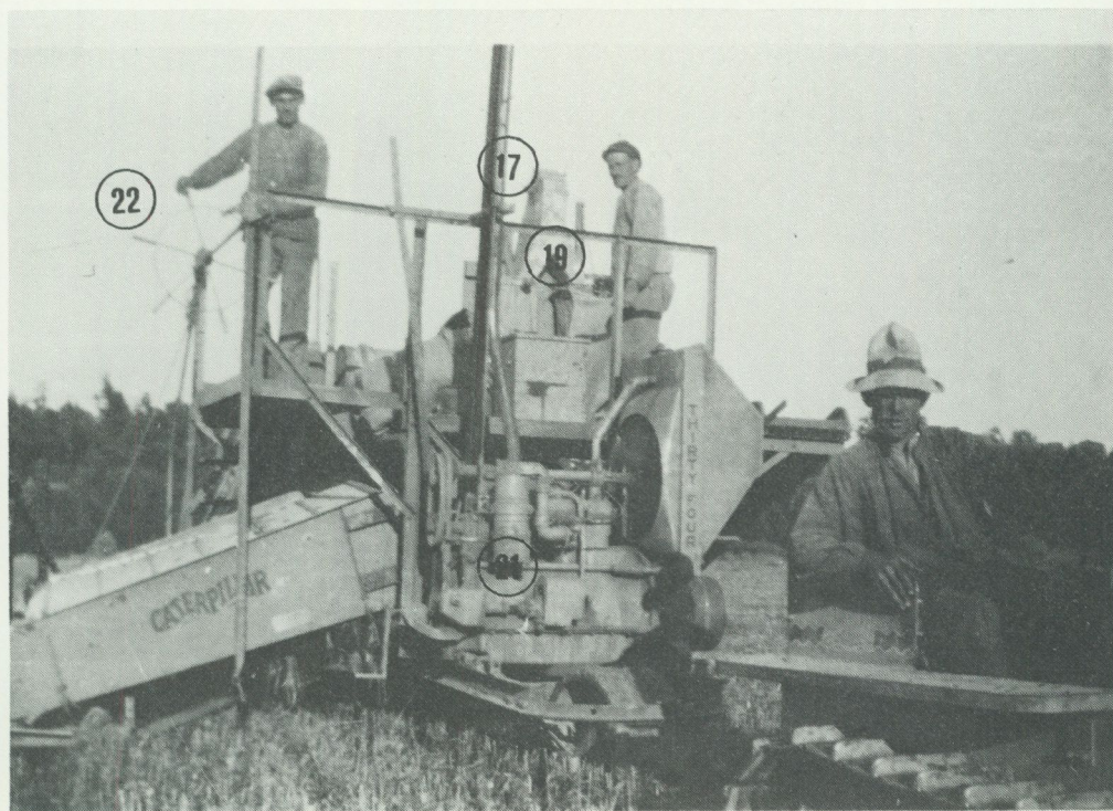
9. Ovan visas hur skäret på Caterpillar-skördetröskan vid skörd i backe kan lutas, medan tröskdelen hålls horisontell av en särskild mekanism. Detta är en specialegenskap, som har kommit tillbaka först på de allra modernaste maskinerna. Teckning Christine Lilja.
