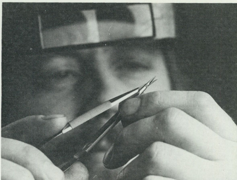
Tillverkning av sax för microkirurgi. Foto Peter Gullers.
