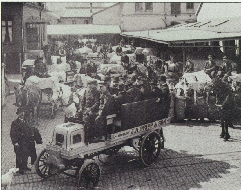
Pripps Daimler lastbil var den första i Sverige. Hjulen var skodda med gummiringar, motorn hade två cylindrar. FOTO: TEKNISKA MUSEET.
