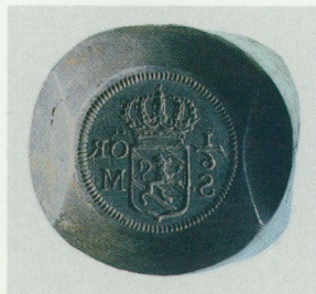
Myntstamper av stål med gravuren 1/6 öre S[ilver] M[ynt]. Stamparna sedda underifrån.
