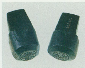
De påträffade myntstamparna sedda snett underifrån från sidan. Med den fyrkantiga bakänden fästes stamparna i myntmaskinen.
