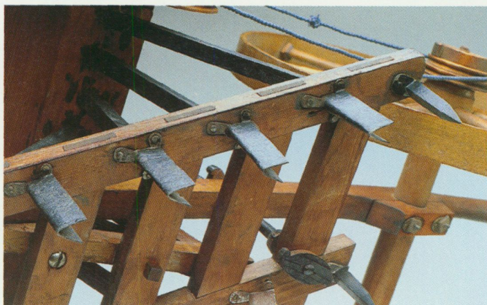
Såharvens underrede med detaljbild av såbillarna.
