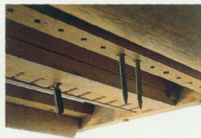
Såmaskinens underdel med detalj av såbill och myllpinnar.
