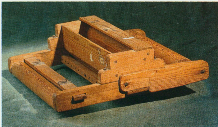
Christopher Polhems såmaskinsmodell, konstruerad senast 1729. Ovanför den främre vältrullen syns de båda anspänningskrokarna. Den bakre rullen driver, genom dolda länkar, utmatningsvalsen.
