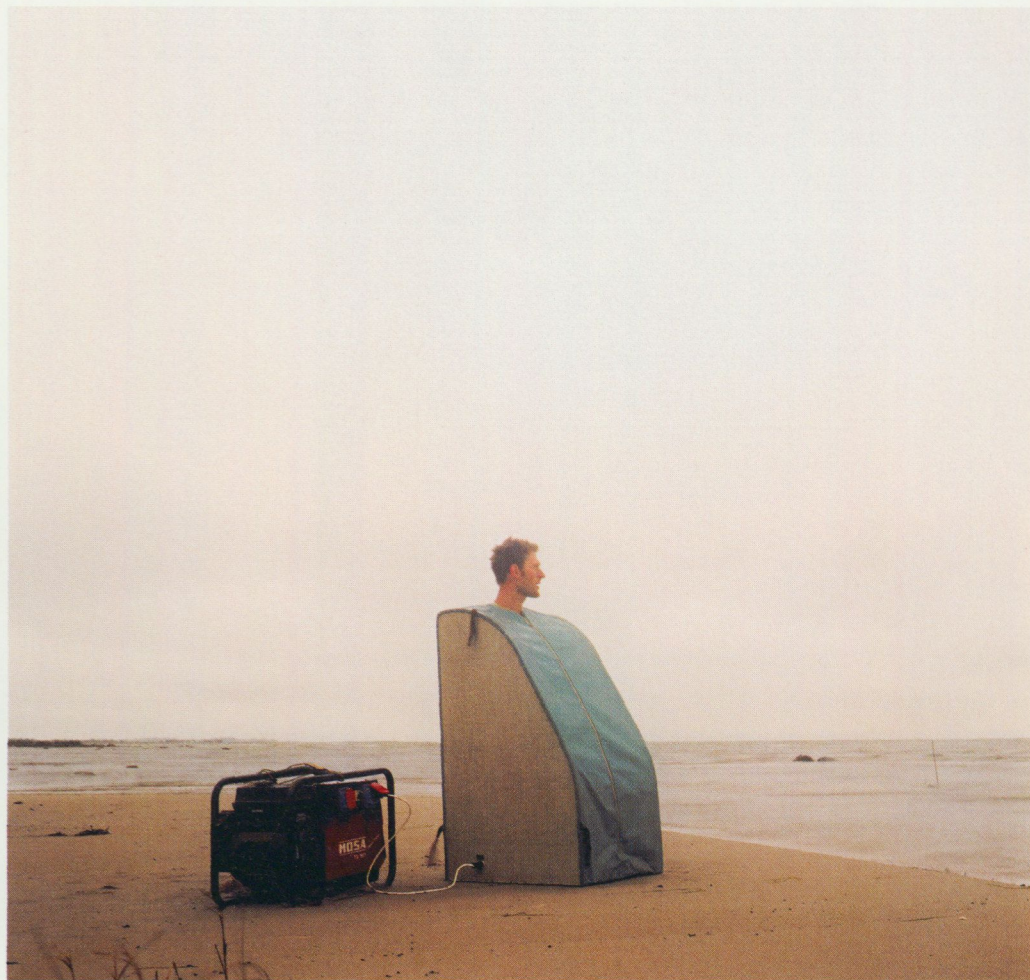
Den hopfällbara enmansbastun uppstod på 1950-talet när svenskt campingliv blomstrade. Under sitsen finns ett elektriskt värmeaggregat på 1000 watt. Här drivs bastun av ett portabelt elverk på en gotländsk strand i novemberdis. Foto Olle Wilson.
