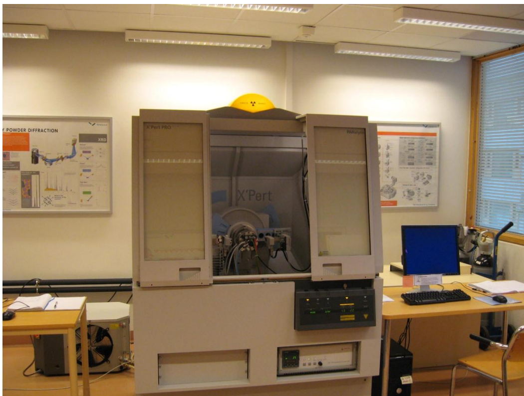
Figur 6. Stockholms Universitets automatiska pulverdiffraktometer PAN Analytical X'Pert PRO (Institutionen för materialkemi).
