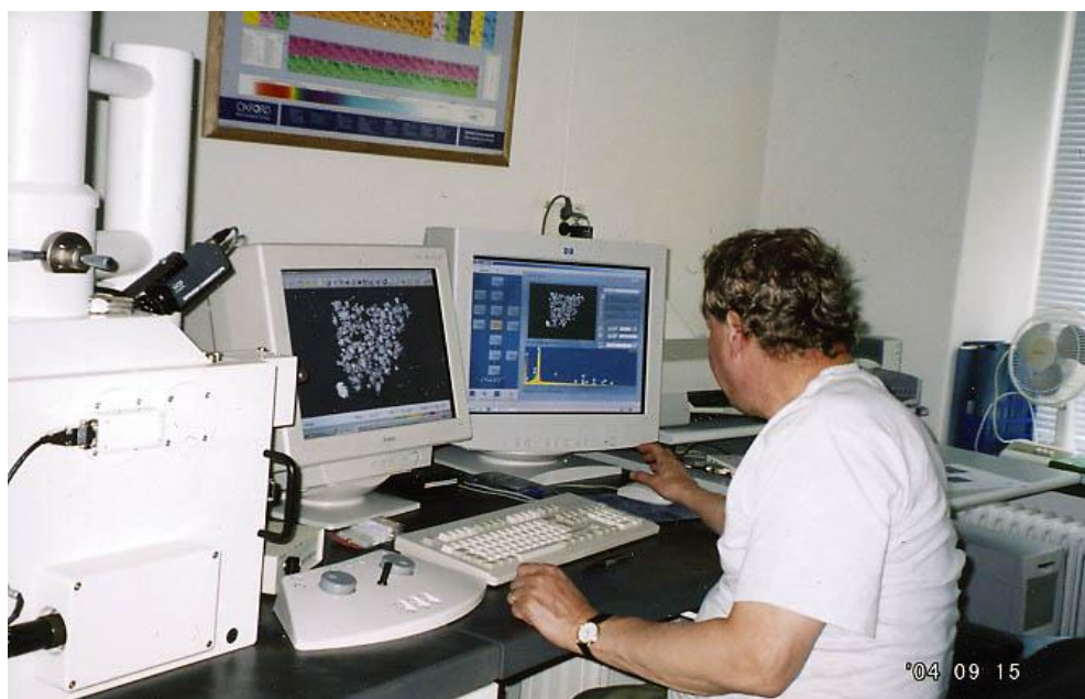
Figur 4. Svepelektronmikroskop LEO 1455VP med en tillsats från LINK/Oxford för mikroröntgenanalys (SEM/EDX). Instrumentet står nu på RAÄ/F i Visby.
