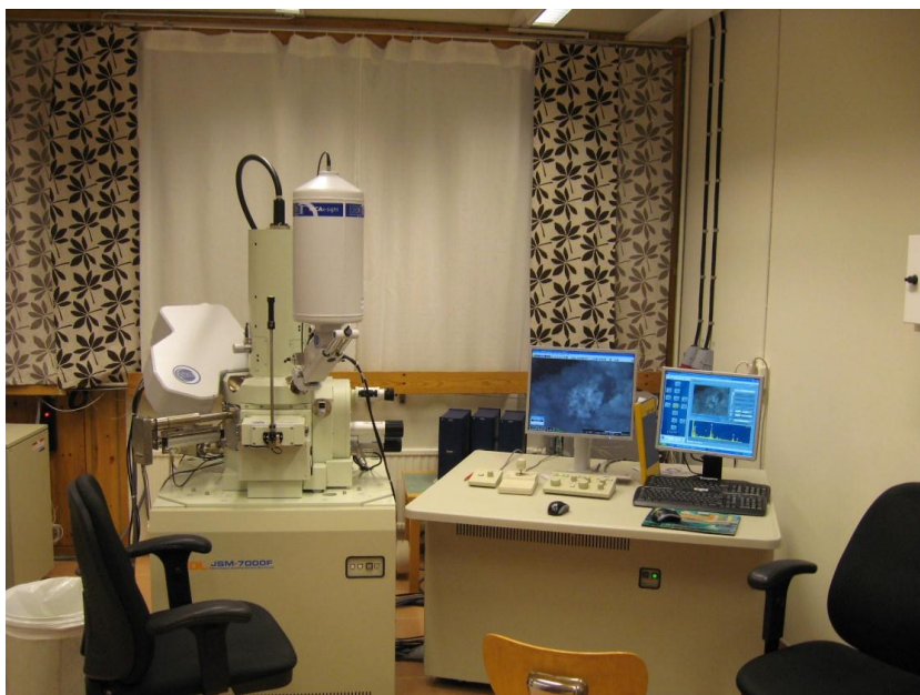
Figur 5. Fältelektronmikroskop (field emission) av modell JEOL JSM-7000F på Stockholms Universitets kemiska sektion.
