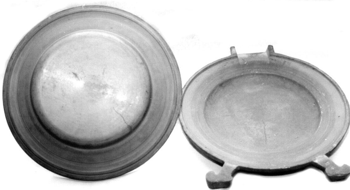
Fig. 5. Metallform för en barockkälad 215 mm tallrik, säkerligen tillverkad av Daniel Björkman år 1725. Detta är en av de äldsta bevarade svenska gjutformarna. (Nr. 3 i tabellen.)
