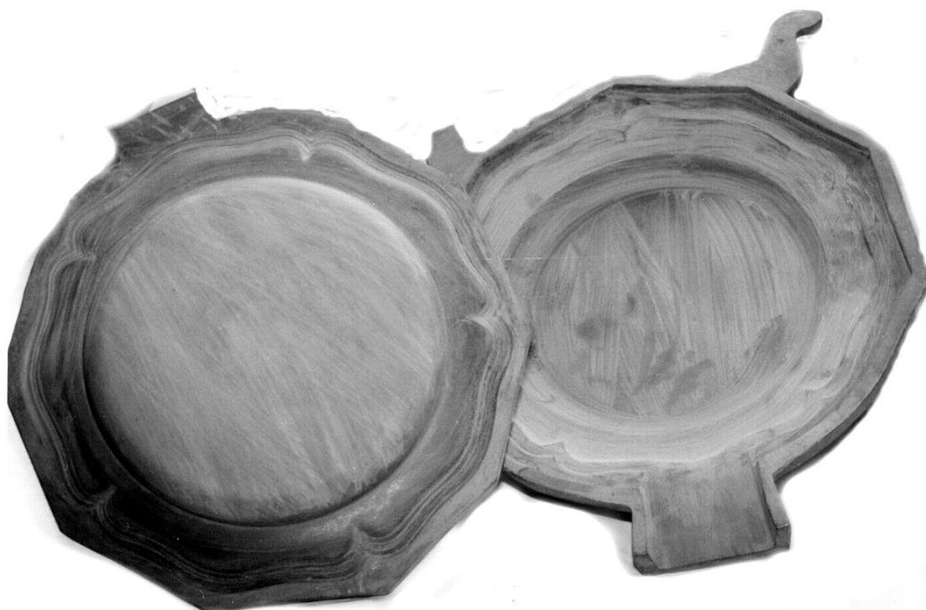
Fig. 4. Carl Wessmans gjutjärnsform daterad 1757/1767 för ett fempassigt fat, nr. 2 i tabellen. Liksom nr. 1 har även denna form de onödiga snibbarna i formens underdel, som medförde extraarbete efter gjutningen eftersom tallrikarna/faten inte kunde svarvas ut till kant. Det är möjligt att både Åberg och Wessman använde tallrikar och fat tillverkade av mästarna i Frankfurt am Main som förlaga (mall/modell) vid formtillverkningen, som skedde i sandflaska. Både före och efter tillkomsten av dessa ämbetsformar tillverkade stockholmsmästarna sina rokokotallrikar/fat med utgångspunkt från vanliga runda tallrikar/fat, som klipptes och formades innan bården applicerades och som därför oundvikligen hade rokokosnibben även på undersidan. Kanske dessa blev gjutmodeller?
