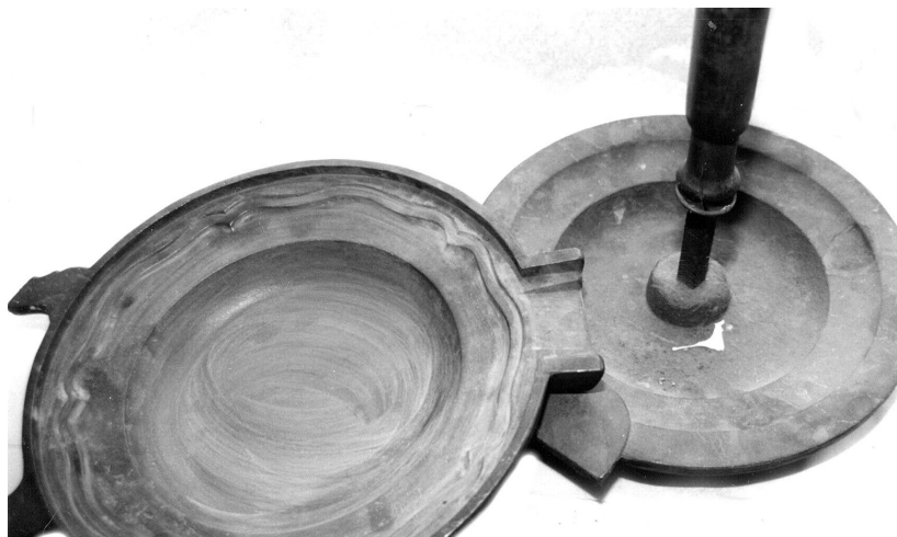
Fig. 3. Peter Åbergs djupa rokokotallriksform av gjutjärn, nr. 1 ovan, daterad 1758. Formunderdelens onödiga snibbar är klart synliga.
