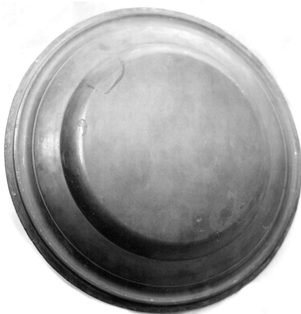
Fig. 5. Metallform för en barockkälad 215 mm tallrik, säkerligen tillverkad av Daniel Björkman år 1725. Detta är en av de äldsta bevarade svenska gjutformarna. (Nr. 3 i tabellen.)
